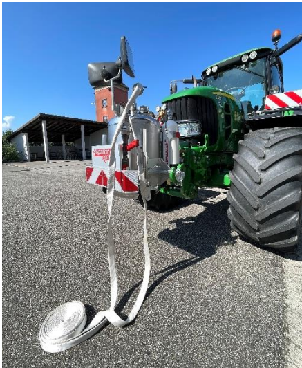
Die mobile Löschanlage Alligator 130 fasst 130 Liter Wasser sowie Schaummittel und gewährleistet im Brandfall eine rasche Intervention. Bezugsquelle: Fiechter Lohnunternehmung, Kappelen. Bild: BUL
