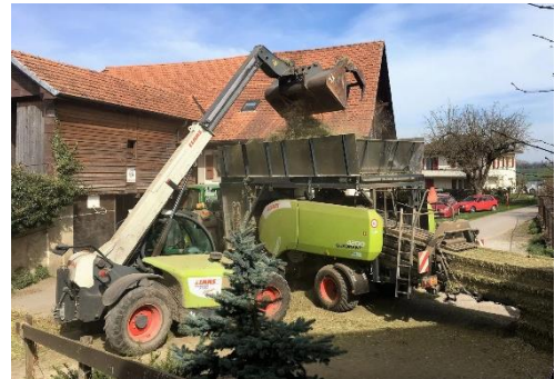
Der Pressvorgang sollte grundsätzlich immer ausserhalb von Gebäuden stattfinden. Bild: Bourguet Mécanique SA
